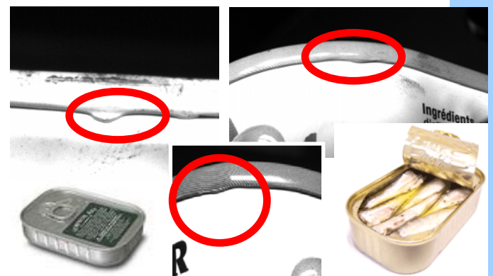
VisioCanEnd: inspección de cierre de latas
